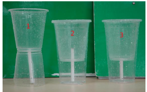
圖3 實驗五 研究高度對吸水速度與吸水量的關係 三種不同設計
