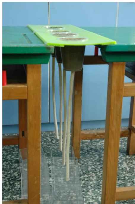
圖 9 實驗八 聚酯纖維棒與粗棉繩輔助吸水實驗
