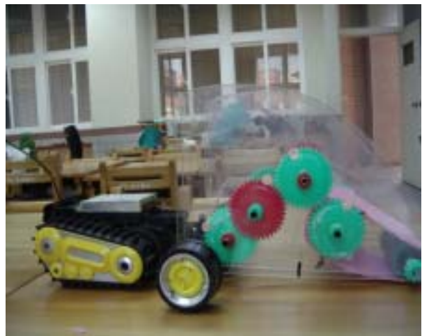
(圖 18) 以二手電動車進行擦地機改造
