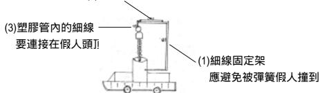
2.原理 避震車經衝撞阻礙物後,假人頭頂上的細線會被假人頭從細管 內拉出,結論:
