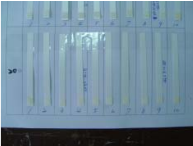
照片 13：加熱 20 分鐘後用試紙檢測二氧化硫的含量
