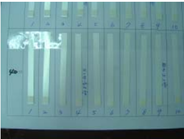
照片 15：加熱 40 分鐘後用試紙檢測二氧化硫的含量
