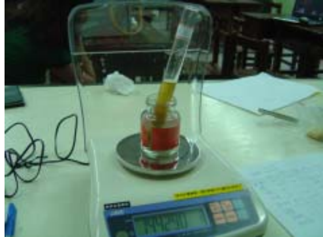
照片 38：量出試管、雞精罐重量
