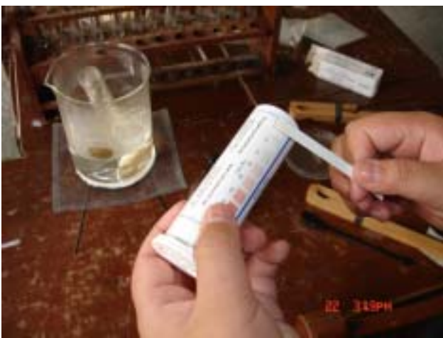
照片 11：以二氧化硫試紙檢測
