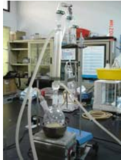
照片 21：以 0.5~0.6 l/min 速度通氮氣，並且加熱
