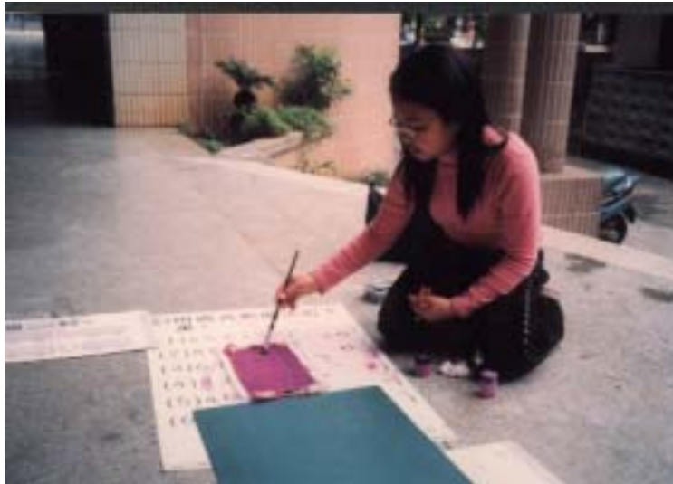
在採樣塑膠盤內墊入 28CM*28CM 抹布，在抹布上塗廣告顏料。
