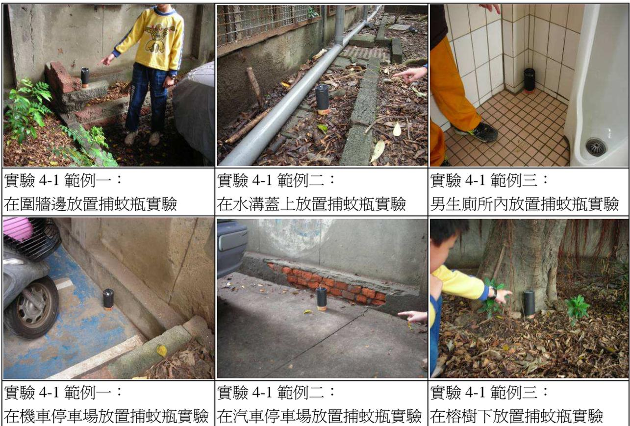
(四) 實驗 4-1：準備十個捕蚊瓶，瓶子周圍貼上蚊子最喜愛的黑色，裡面裝入蚊子最喜愛的水溶液（酵母粉加紅糖水），請同學們將捕蚊瓶放在校園中蚊子較多的角落，一共選定校園中十個地點進行吸引蚊子實驗，記錄每天捕蚊瓶淹死蚊子的累計數量。下表為實驗數據：
