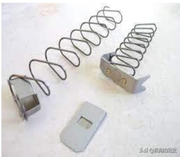
彈簧受外力作用產生形變，在**一定的範圍內**，外力移除後還**能恢復原狀**；一旦受力到某個程度，彈簧便無法恢復原狀了。有彈性的物體所能承受的最大作用力數值，稱作**彈性限度**。
